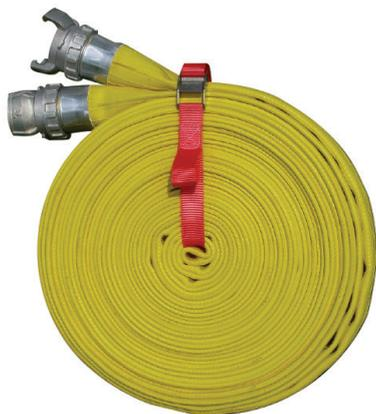
Tuyau haut de gamme de classe A. Principalement utilisé pour des interventions sur feux de forêt. Certifié NF-S 61-112 relative aux tuyaux et NF-S 61-111 relative au flexible. Dispose d'une excellente résistance à tous niveaux et ne requiert pas d'entretien particulier. Une simple vulcanisation à chaud est recommandée en cas de réparation.
