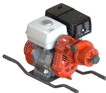
Motopompe à incendie haute pression alimentée par un moteur Honda 13 HP et un mécanisme d'entraînement vertical de configuration portable avec châssis tubulaire, réservoir de carburant, amorceur manuel et clapet antiretour.
