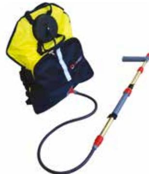
Sac avec intérieur en PVC imperméable très résistant. Muni d'une vanne de connexion rapide avec 1/4 de tour à la sortie du sac permettant le retrait ou la fixation du tuyau (même si le sac est rempli) sans perte de son contenu. Lance double action : jet plein avec portée de 12 m ou brume avec portée de 3 m.
