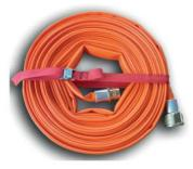
Tuyau très léger et peu encombrant fabriqué par procédé d'extrusion d'un polyuréthane (3 fois plus résistant qu'un caoutchouc Nitrile/PVC). Tuyau pour usage feux de forêt. Bonne résistance abrasion, coupure. Excellente résistance à l'ozone et aux U.V. Excellente résistance aux intempéries et conserve toutes ses caractéristiques techniques à très basses ou hautes températures ambiantes (-40°C à +70°C)
